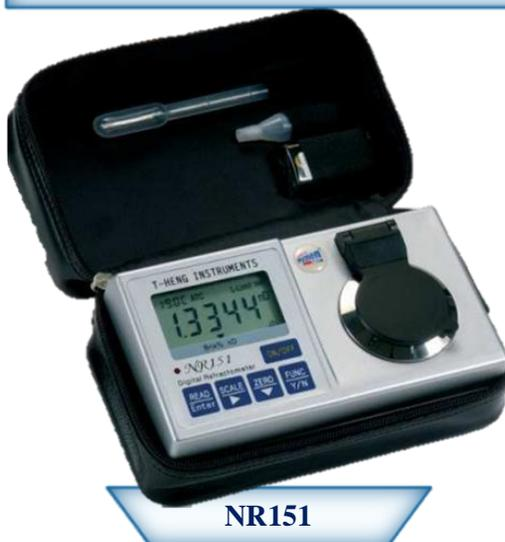
**Método:** Refractometría óptica digital, detección de imagen óptica con fotocélulas integradas en una cámara CCD y procesamiento digital de imágenes.
