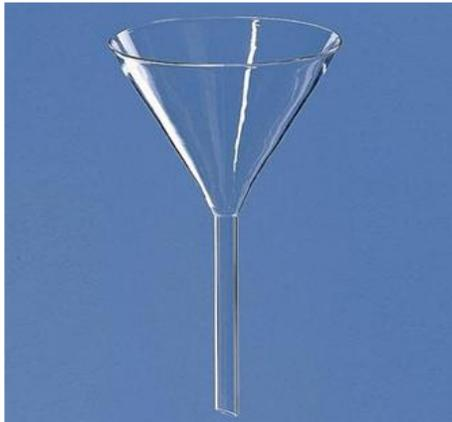
Diseñado para el trasvase seguro de líquidos y soluciones, evitando derrames y pérdidas. Su geometría permite canalizar el flujo hacia recipientes de menor diámetro, y se puede utilizar con papel filtro para procesos de filtración.
