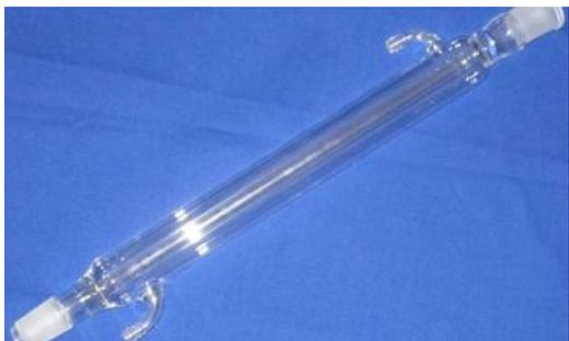
Utilizado en química para condensar vapores de sustancias líquidas o solventes, transformándolos nuevamente en líquido durante procesos como destilaciones o reflujo. Generalmente está fabricado en vidrio borosilicato, resistente al calor y a los productos químicos.
