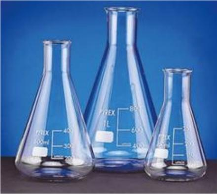
Base amplia y cuello estrecho que facilita la mezcla de soluciones sin riesgo de derrame. Su geometría permite una agitación eficiente y un calentamiento uniforme de líquidos
