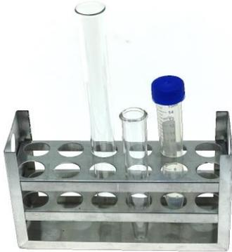
Soporte de metal utilizado para sostener y organizar tubos de ensayo o tubos de centrifugación en posición vertical durante experimentos.
