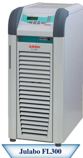
**Método:** Refrigeración por circulación de agua mediante un sistema de bomba interna que fuerza el flujo del líquido a través de un intercambiador de calor tipo placa.
