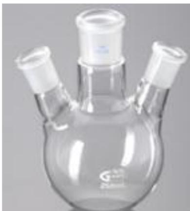
Recipiente de vidrio borosilicato con fondo redondo y tres bocas inclinadas, diseñado para trabajos de síntesis y reacciones químicas que requieren la conexión simultánea de diferentes accesorios (refrigerantes, embudos de adición, termómetros, etc.).
