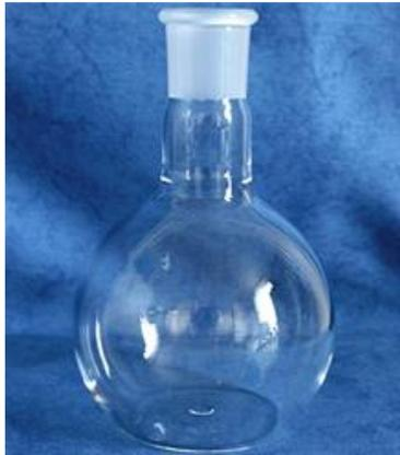
Recipiente de vidrio borosilicato con forma esférica y cuello estrecho. Su diseño permite una distribución uniforme del calor durante el calentamiento y reduce las pérdidas por evaporación. Se emplea en la preparación de soluciones, reacciones químicas, destilaciones y almacenamiento temporal de líquidos.
