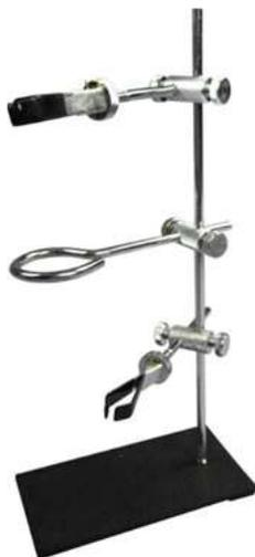
Proporcionar un punto de sujeción estable para montar y asegurar instrumentos de laboratorio, facilitando la realización de experimentos que requieren fijación vertical u horizontal de equipos y accesorios.
