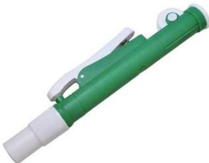
Dispositivo de succión fabricado en material plástico resistente, diseñado para aspirar y dispensar líquidos de manera segura en pipetas graduadas o volumétricas. Incluye válvula de control para regular el flujo del líquido y evitar derrames.
