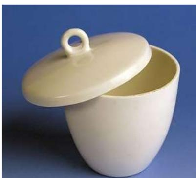
Diseñados para contener y someter muestras sólidas a temperaturas elevadas durante procesos de calcinación, fusión o análisis gravimétrico. Su construcción permite resistir choques térmicos y la acción de reactivos químicos corrosivos, asegurando integridad del material y precisión en los resultados experimentales.
