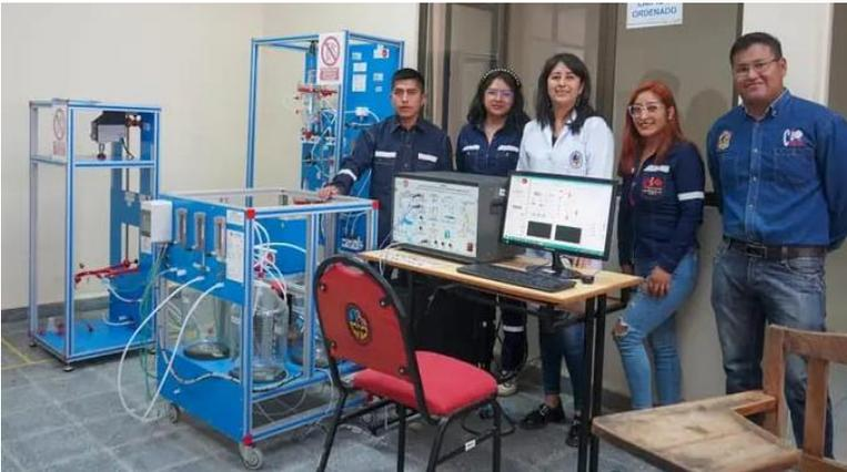
Operaciones Unitarias II prácticas en distintos tipos de intercambiadores de calor, Operaciones Unitarias III con torre de destilación de platos y empacadas, Laboratorio de Procesos, Refinación para destilación normalizada ASTM de hidrocarburos, laboratorio de Lodos para prácticas de análisis químico de lodos en perforación hidrocarburos, Todos estos equipos tienen interface a computadora controlables desde software o manualmente.
